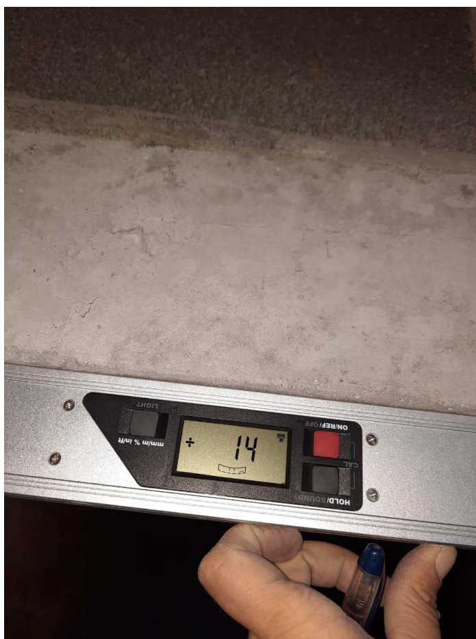
Фотография 11-12. Отклонение балки от горизонтальной плоскости
