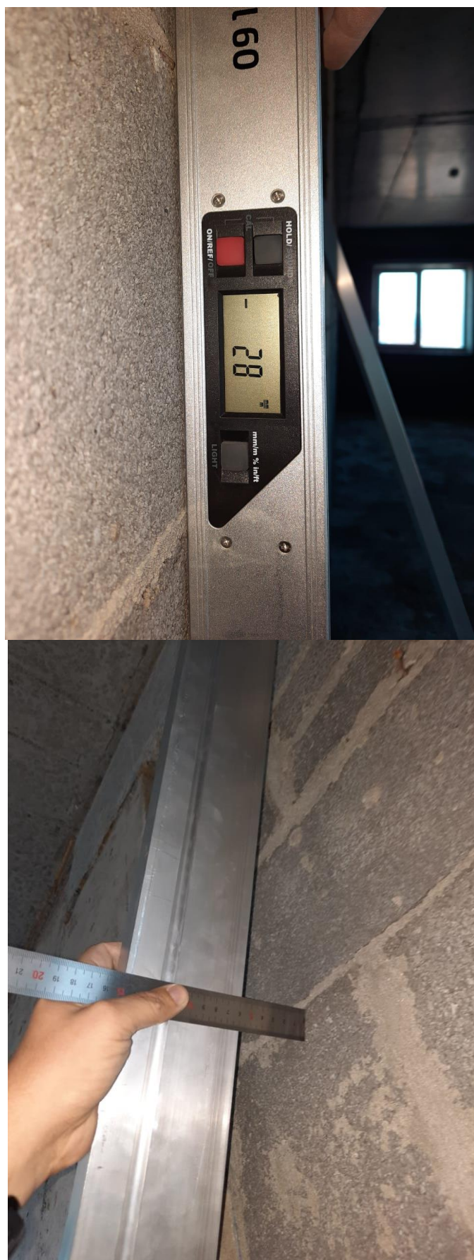
Фотография 9-10. Замер величины отклонения от вертикальной плоскости.
