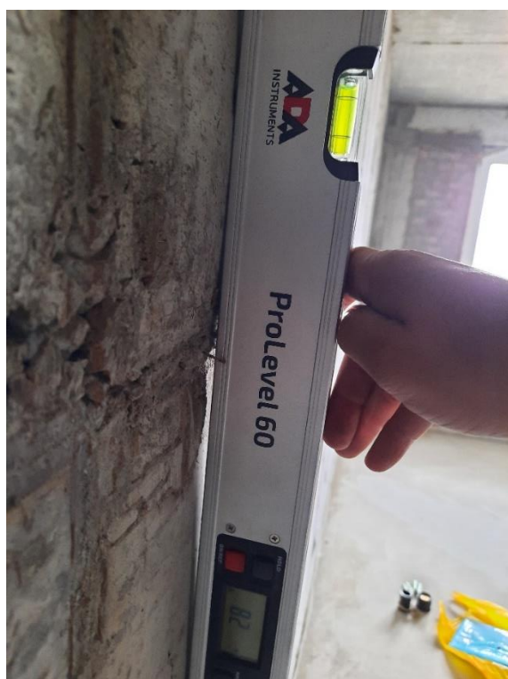
Фотография 4,5,6. Наплавы бетона, искривление по вертикали монолитных стен
